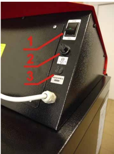
Bild 17. 1 – Hauptschalter, 2 – Havarie Thermostat, 3 – Sicherung (F6,3A)
