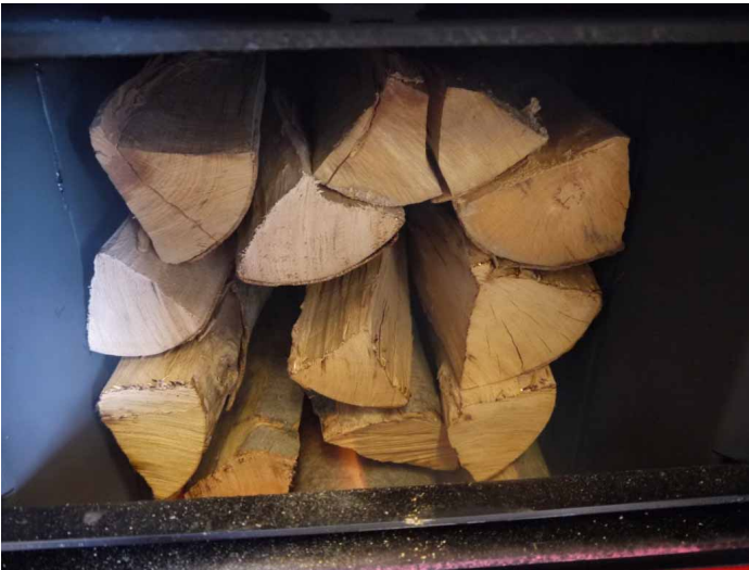
Bild 12. Das Nachlegen bis die Kammer voll ist
